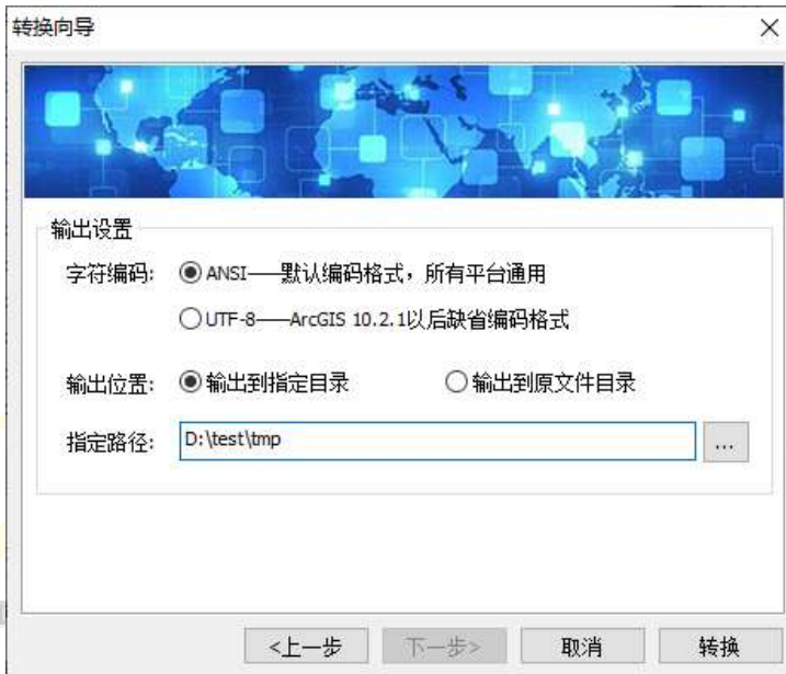
图 2-10 选择字符编码及输出路径
