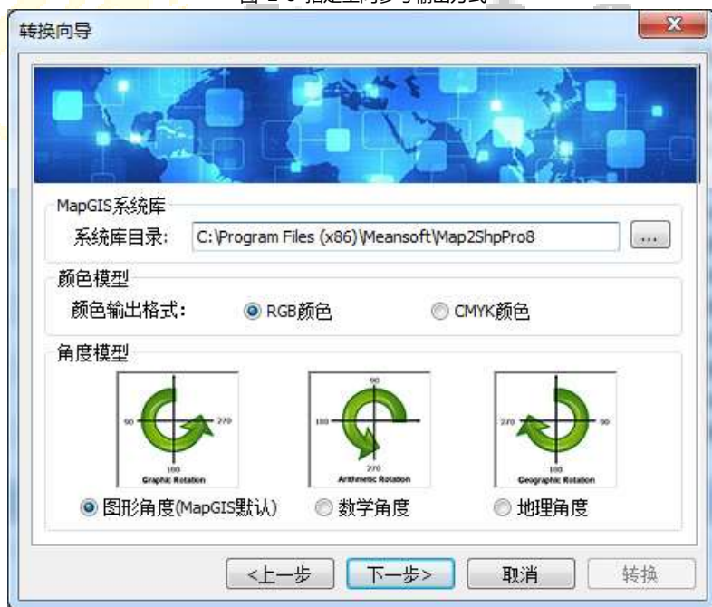
图 2-9 指定 MapGIS 原图系统库及颜色角度输出方式
