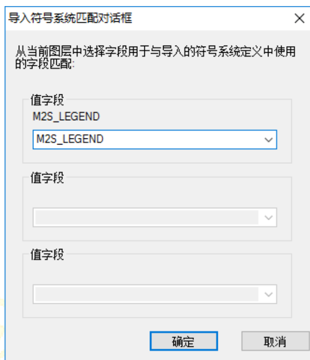
图 2-20 ArcGIS 导入符号系统匹配字段
