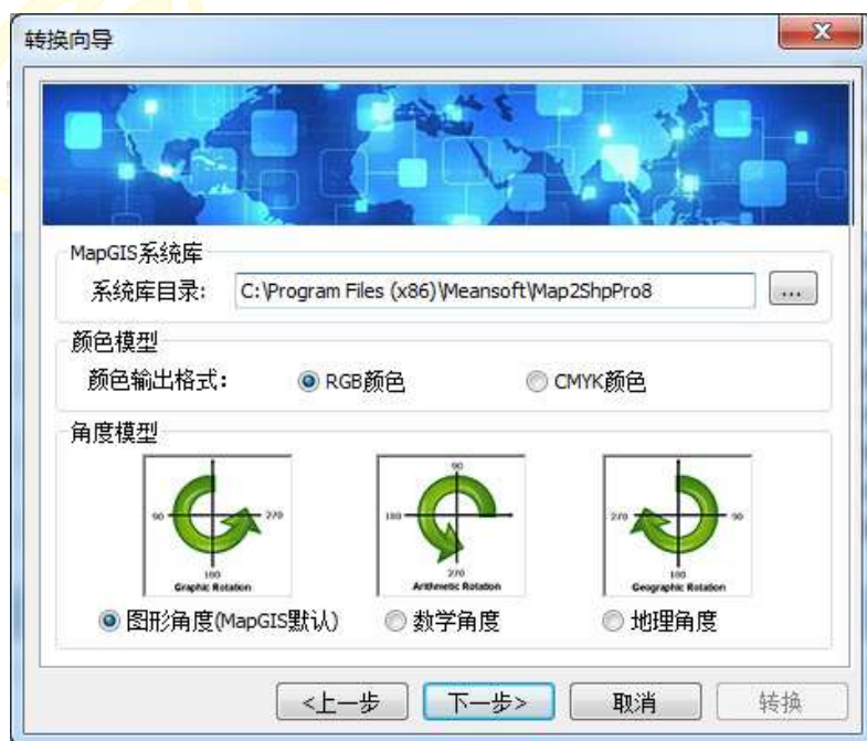
图 2-16 指定 MapGIS 原图系统库及颜色角度输出方式
